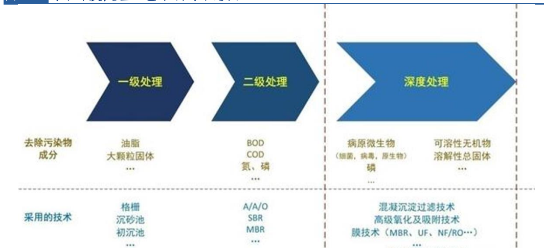
图 56: 污水深度处理工艺路线的示意图
