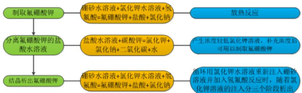
图表 28：半成品氟硼酸钾的生产工艺流程图
