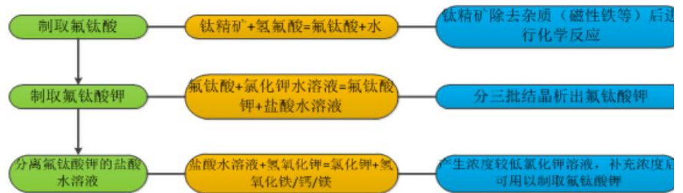
图表 27：半成品氟钛酸钾的生产工艺流程图
