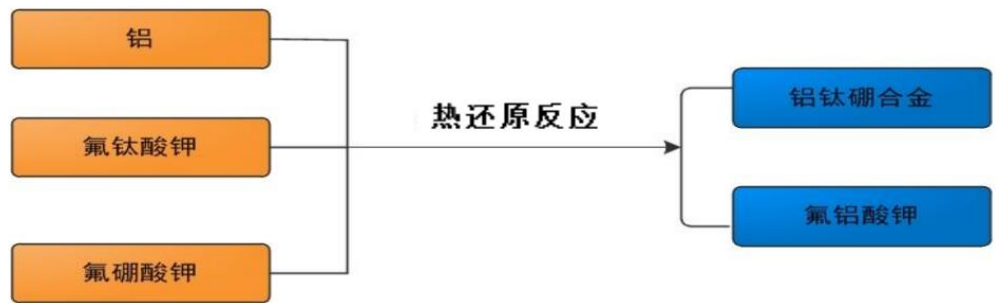
图表 26：副产品氟铝酸钾生成工艺流程图
