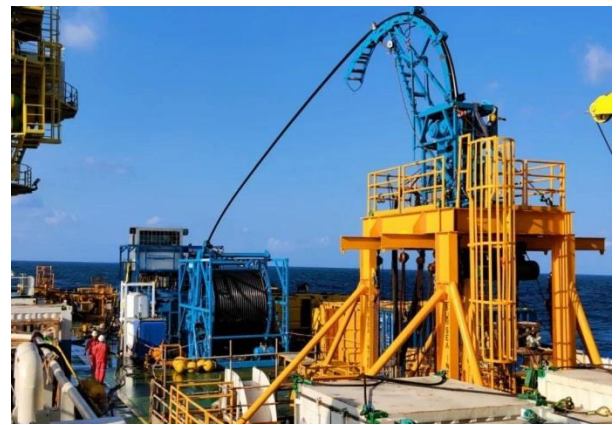
图 55：国内首套大管径连续油管作业橇组在南海成功应用
