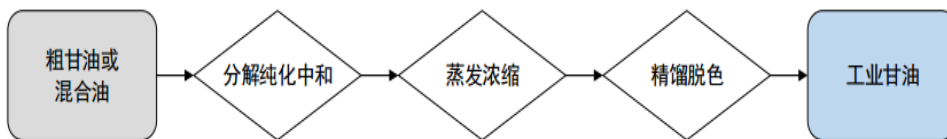
图 36：公司制备工业甘油工艺流程
