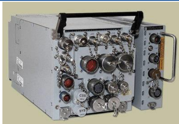
图 18: 美国 Link-16 数据链使用的 MIDS-LVT 终端机
