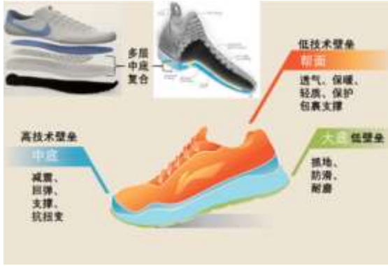
图 53: 一般运动鞋分层结构及功能特点
