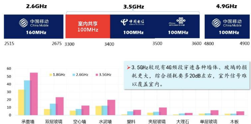
图 18: 3.5Ghz 较现有 4G 频段穿透各种墙体、玻璃的综合损耗增加 20dB
