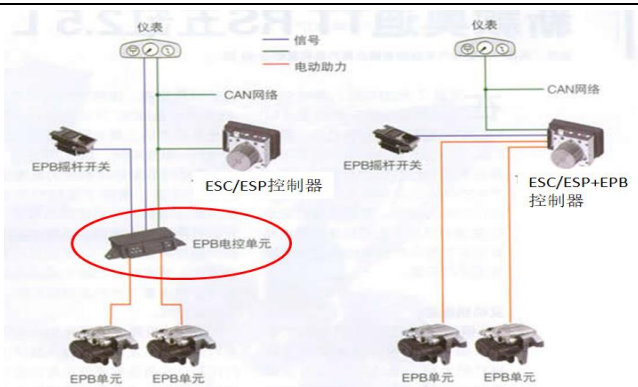
图表29.EPB 与 EPBi 系统架构对比
