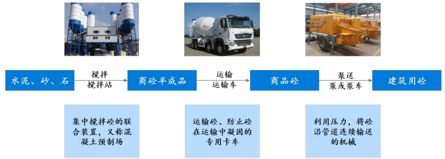
图 8: 预拌混凝土生产工序
