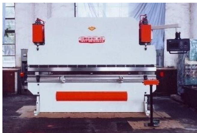
图62：公司首台自主研发的数控板料折弯机
