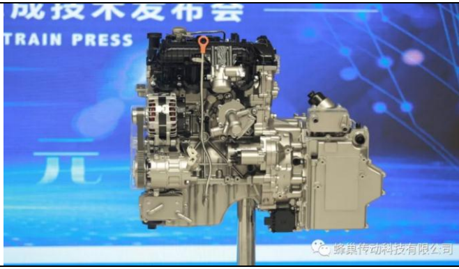
图10 4N20 发动机+9DCT 变速器动力总成
