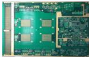
通信骨干网传输用高速系统板
