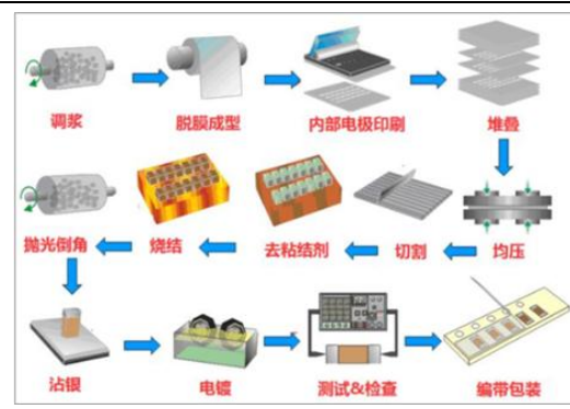
图 50: MLCC 制作工艺流程图
