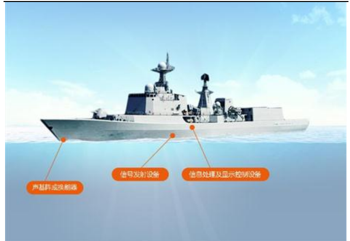
图14 水声信息传输装备在海洋通信体系中的应用
