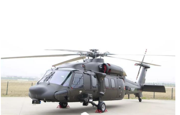
图6：直-20的五桨叶旋翼
