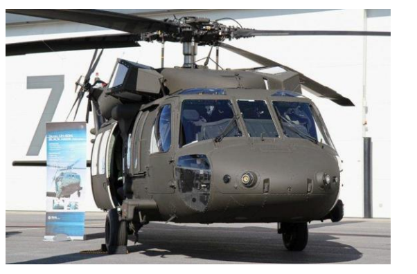
图7：黑鹰的四桨叶旋翼
