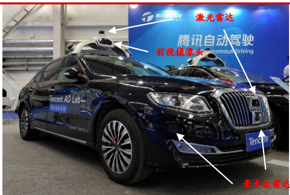
图 66 腾讯自动驾驶测试车的传感器布局
