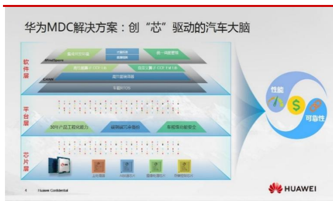
图 101 华为 MDC 解决方案三层架构
