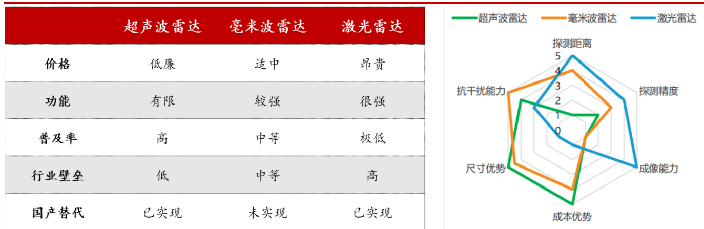
图 77 超声波/毫米波/激光雷达的特性比较
