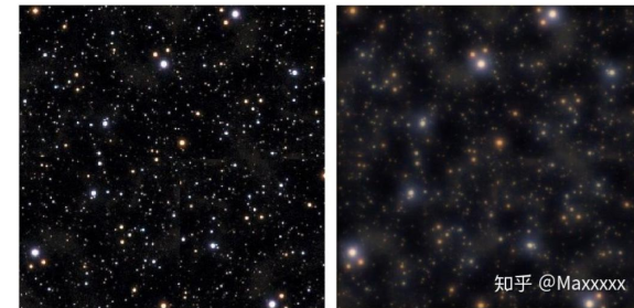
校正过球差 (左图) 和未校正球差 (右图) 的镜头拍摄照片对比
