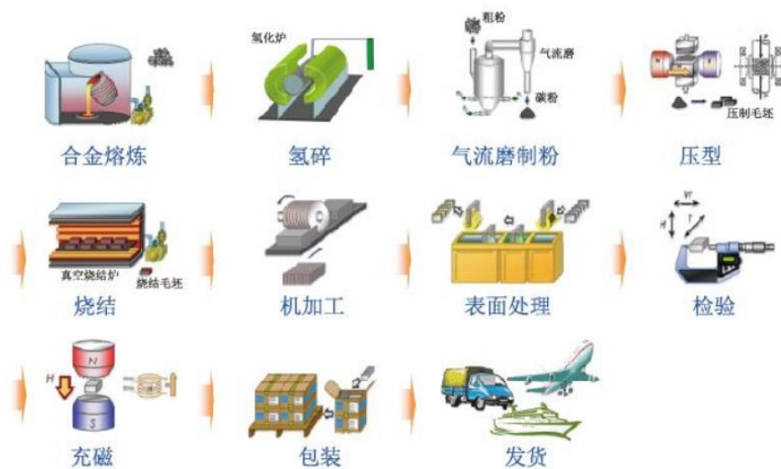
图 31: 烧结钕铁硼生产工艺流程
