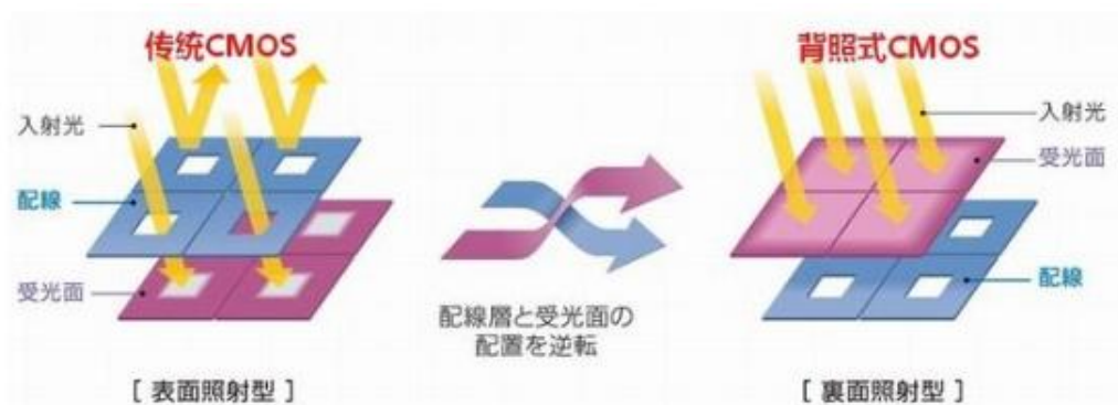
图 13：传统 CMOS 和背照式 CMOS 设计原理
