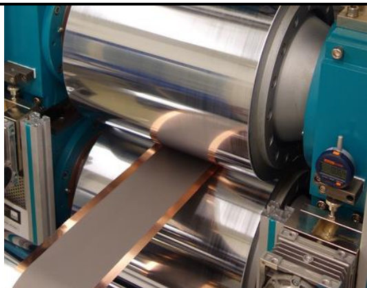
图 7、电池极片的辊压工序
