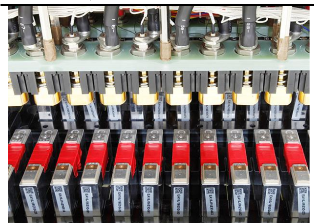
图 19、杭可科技的方型电池负压化成设备
