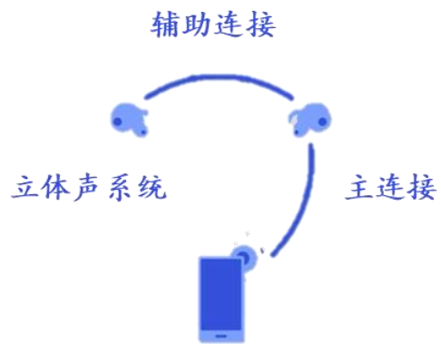
图 13: TWS 耳机工作原理
