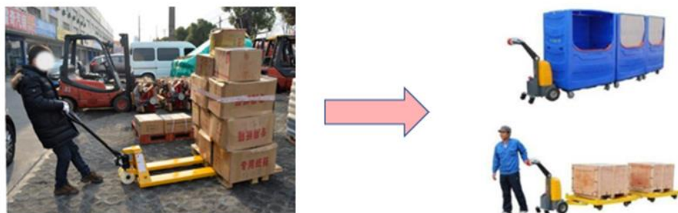
图 29：电动步行式仓储叉车替代人工板车作业
