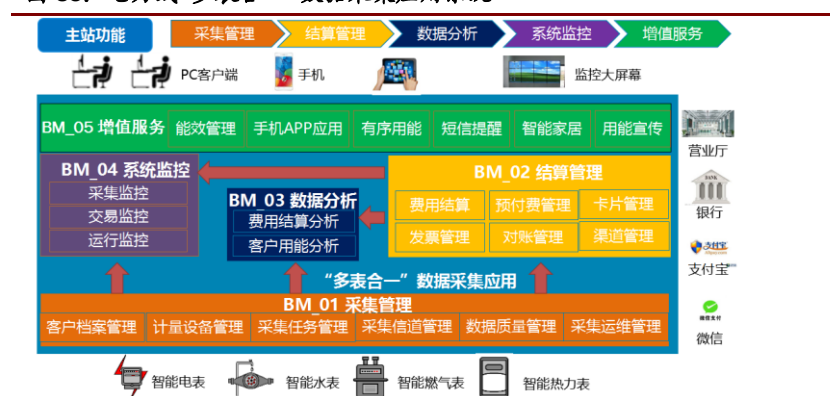
图 35：电力线“多表合一”数据采集应用系统
