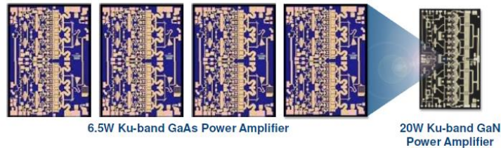
图表 35: GaN 较 GaAs 大幅减少体积
