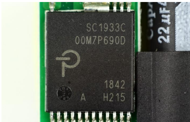
图表 46: anker 采用了 PI 的 SC1933 氮化镓功率产品
