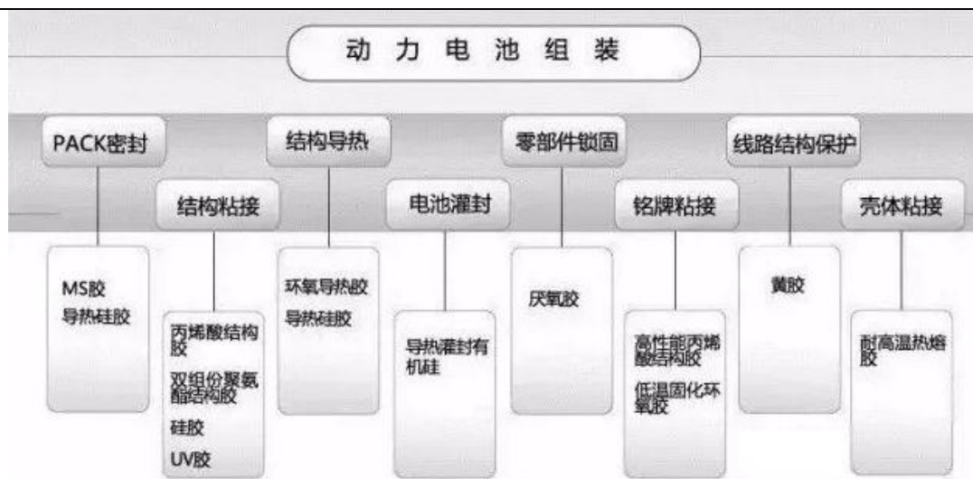
图 15：胶粘剂在动力电池组装中的应用
