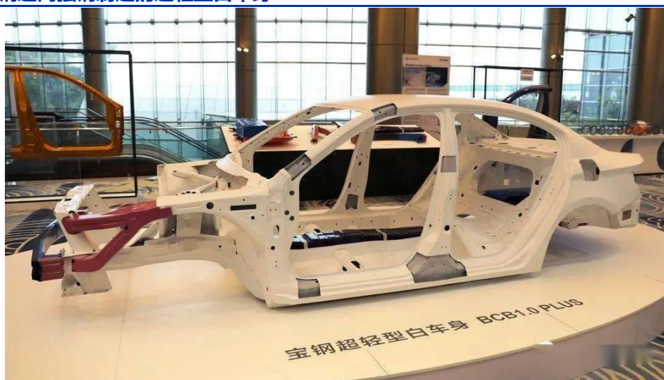
图 12：应用宝钢超高强钢制造的超轻型白车身 BCB 1.0 PLUS
