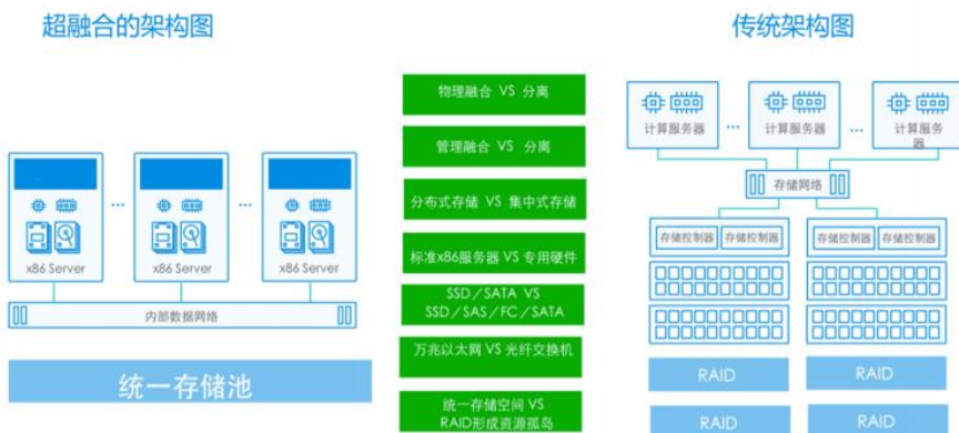
图48 超融合结构和传统 IT 架构对比
