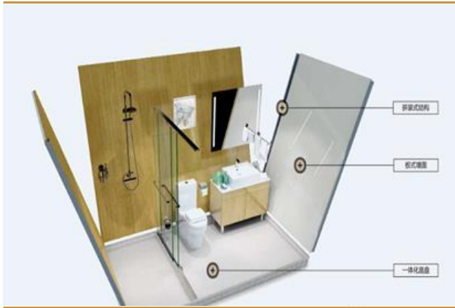
图 13: 装配式卫生间结构图
