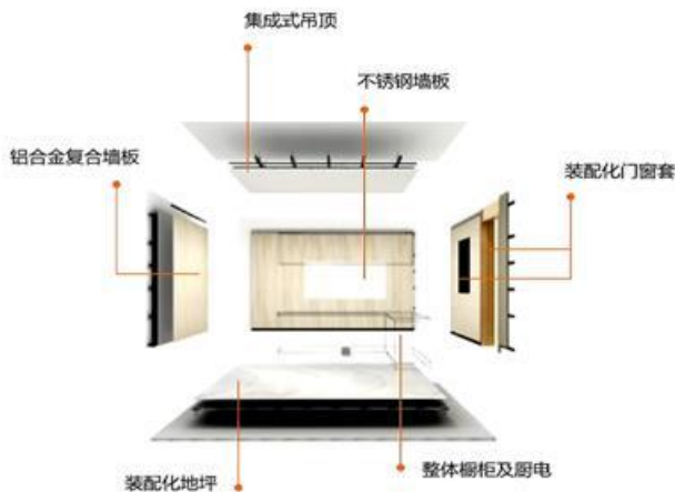
图 1：装配式装修结构图
