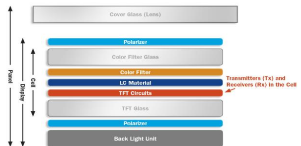
图表 82：In-cell 设计
