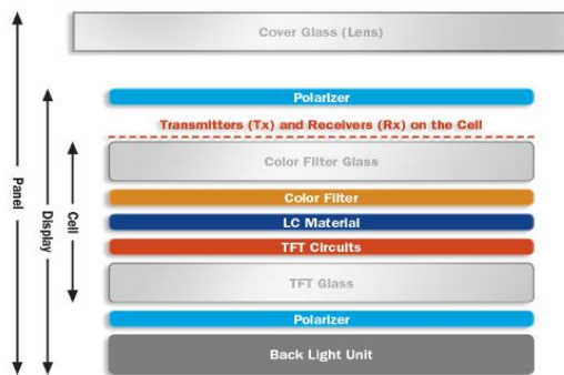
图表 81：On-cell 设计
