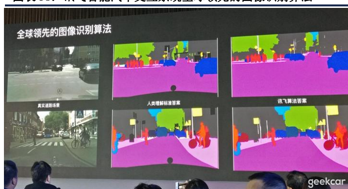
图表 58：讯飞智能汽车交互系统全球领先的图像识别算法
