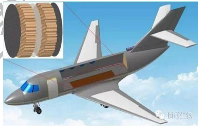
图表 27: 降低飞机飞行噪音的蜂窝轻量膜
