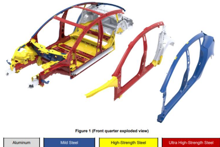
图 50: 特斯拉 model 3 为了降低制造成本采用了钢铝合金车身结构
