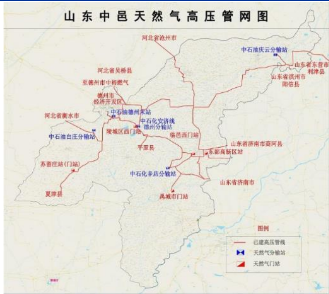
图 14：山东中邑高压管网图
