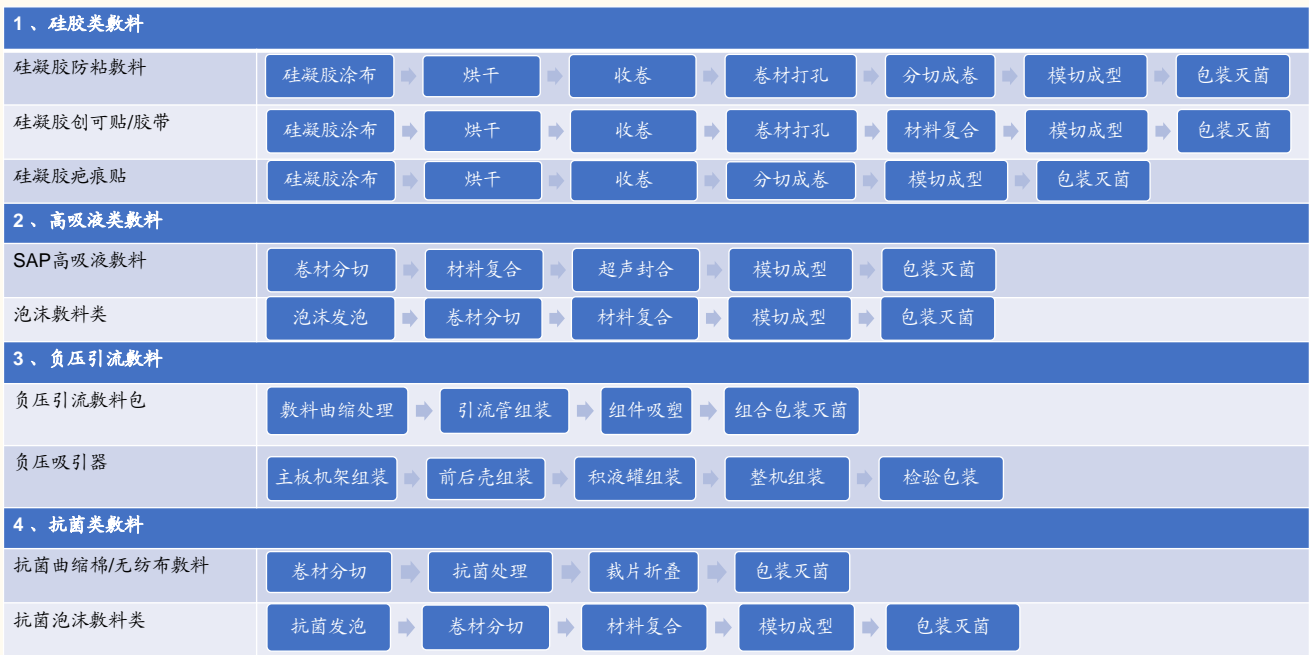
图表 40: 高端敷料生产线产品工艺流程
