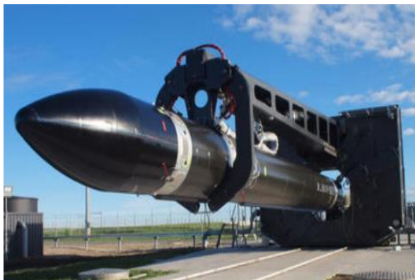
图 31: 使用碳纤维头锥制造的火箭
