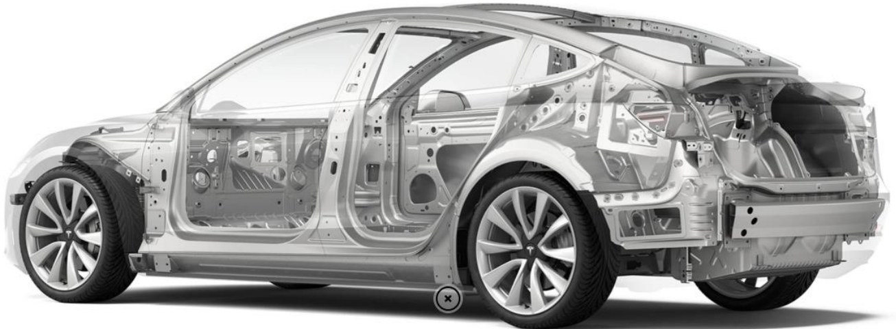
图 3：特斯拉 Model 3 的车身结构
