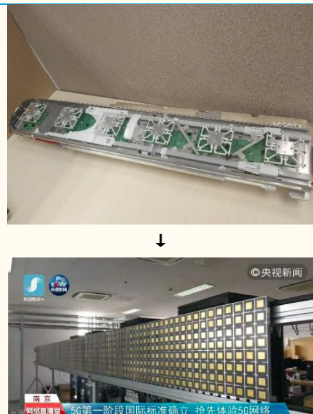
图表 28：4G 中 6 个振子变为 5G 中 Massive MIMO
