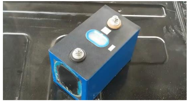
图 43：配套荣威 ER6 的 199Ah 大电芯
