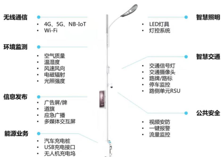
图 17：智慧路灯集多功能为一体
