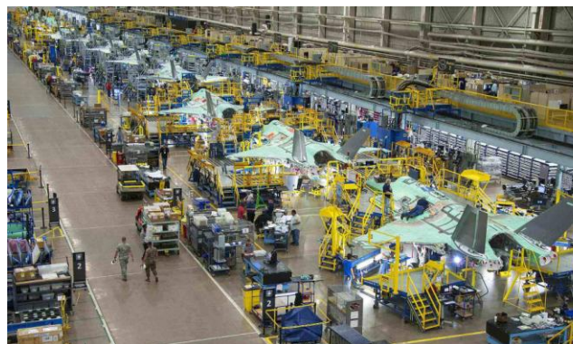
图 33: F-35 总装生产线
