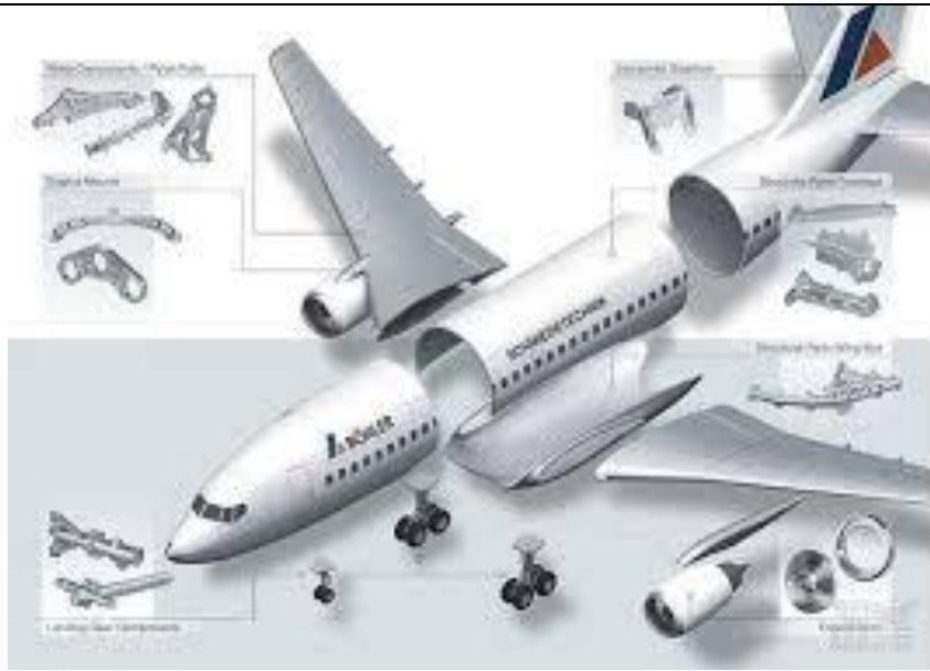
图 30: 典型飞机的结构分段
