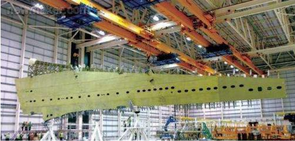
图 22: A380 大型客机机翼下壁板
