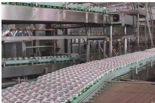
图 42：青啤全自动化易拉罐生产线
