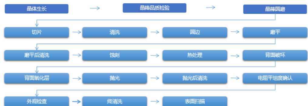
图 17：单晶硅棒及抛光片加工流程
