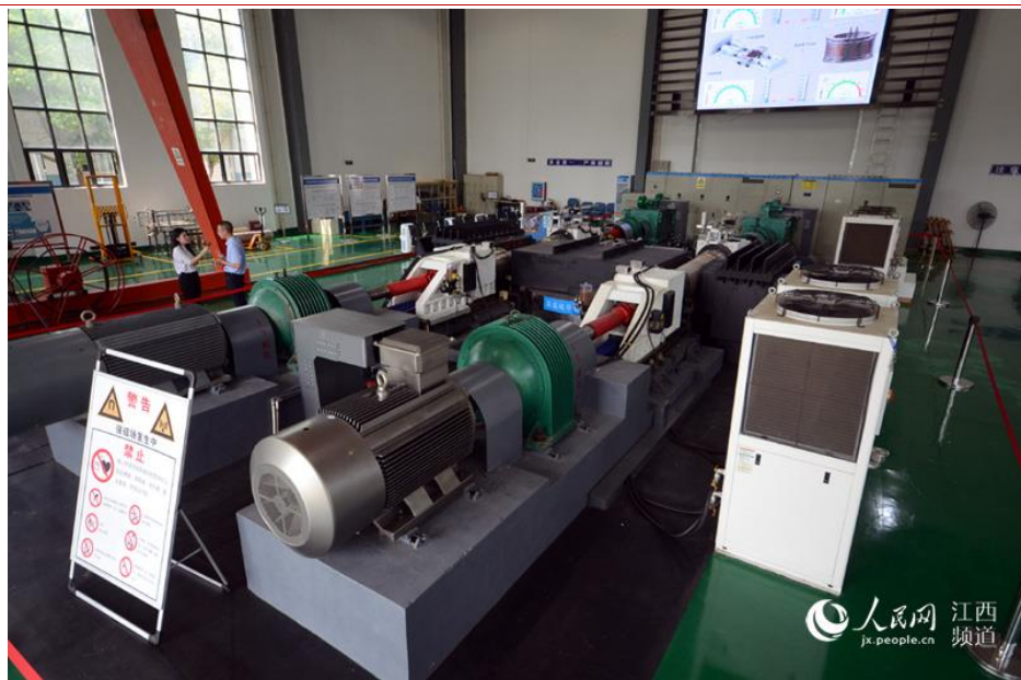
图表 33：江西超导全球首台兆瓦级高温超导感应加热设备
