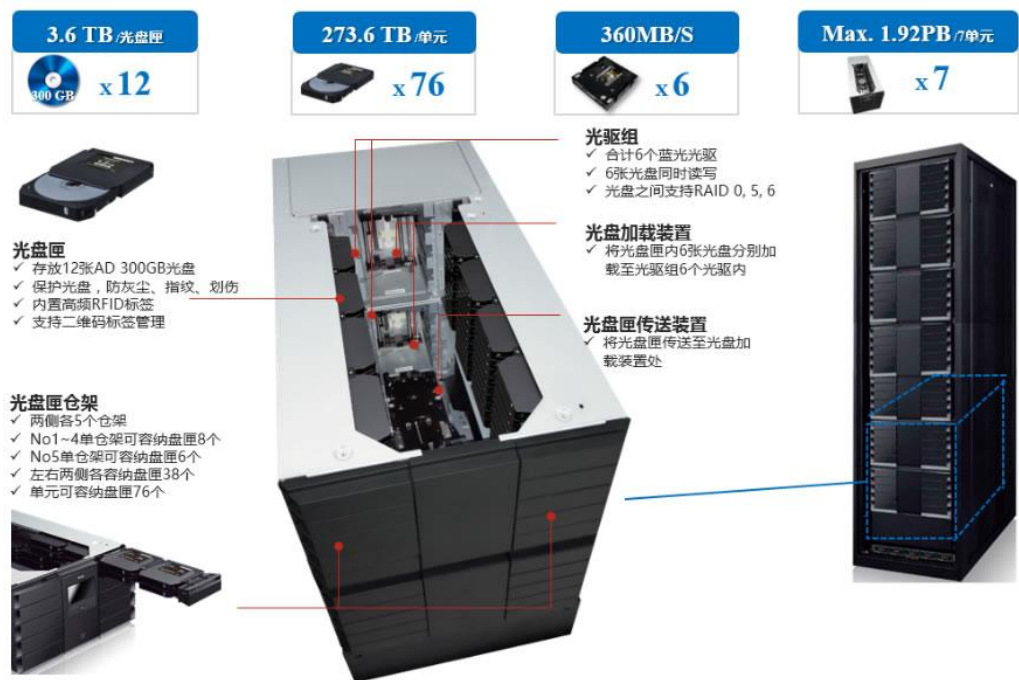
图 9：华录存储蓝光单机柜容量可达 1.92PB
