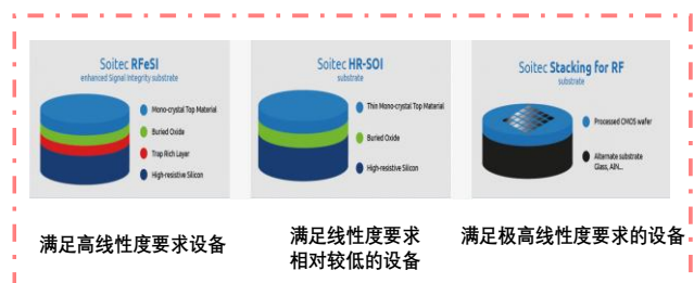
图 30: SOI 技术可覆盖对线性度有不同要求的设备
