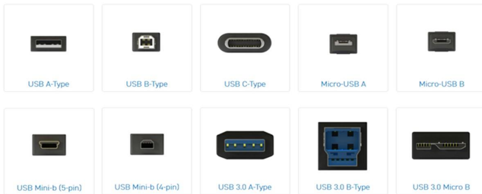
图表1: USB 接口种类较多，其中汽车使用较多的是 Type-A
