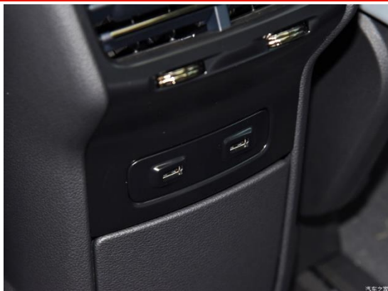
图表6：众多车型后排配备 USB Type-A 充电口
