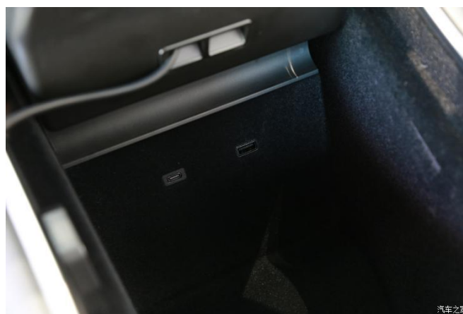
图表5：特斯拉 Model 3 前排标配 USB-C 接口
