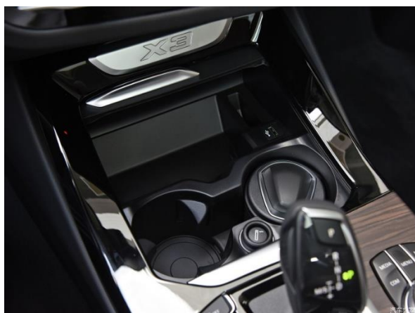
图表4：宝马 X3 前排配备点烟器和 USB type-A 充电口
