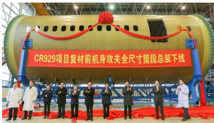
图 28：中航复材助力 CR929 复材前机身攻关全尺寸筒段总装下线
