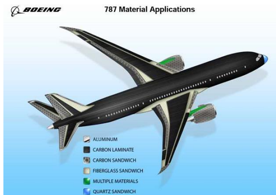
图 17：787 机身结构材料应用分布
