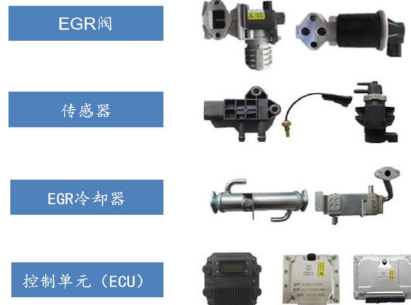
图 8：EGR 主要零部件构成
