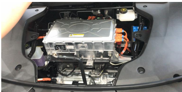
图 6：门店销售展示“汉”的自制电机（机舱内下部）、电控（机舱内上部）
