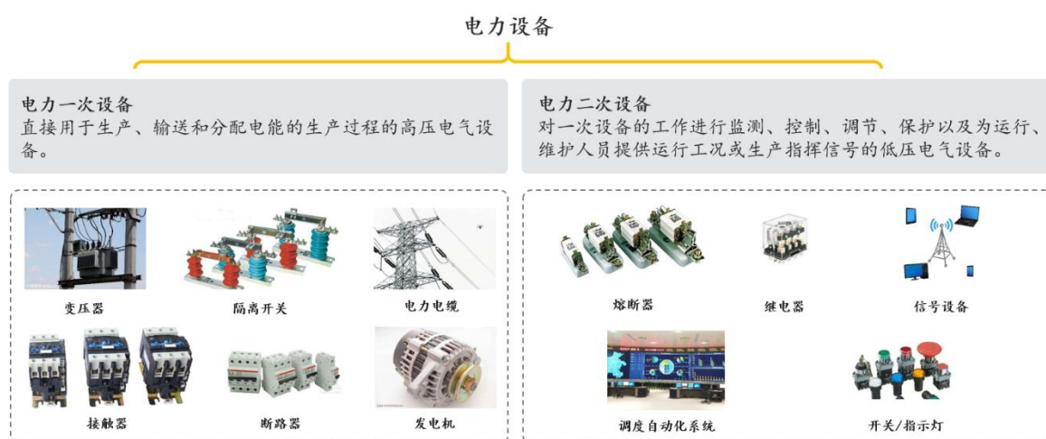
图 14、二次电力设备相当于电力系统中的“软件”
